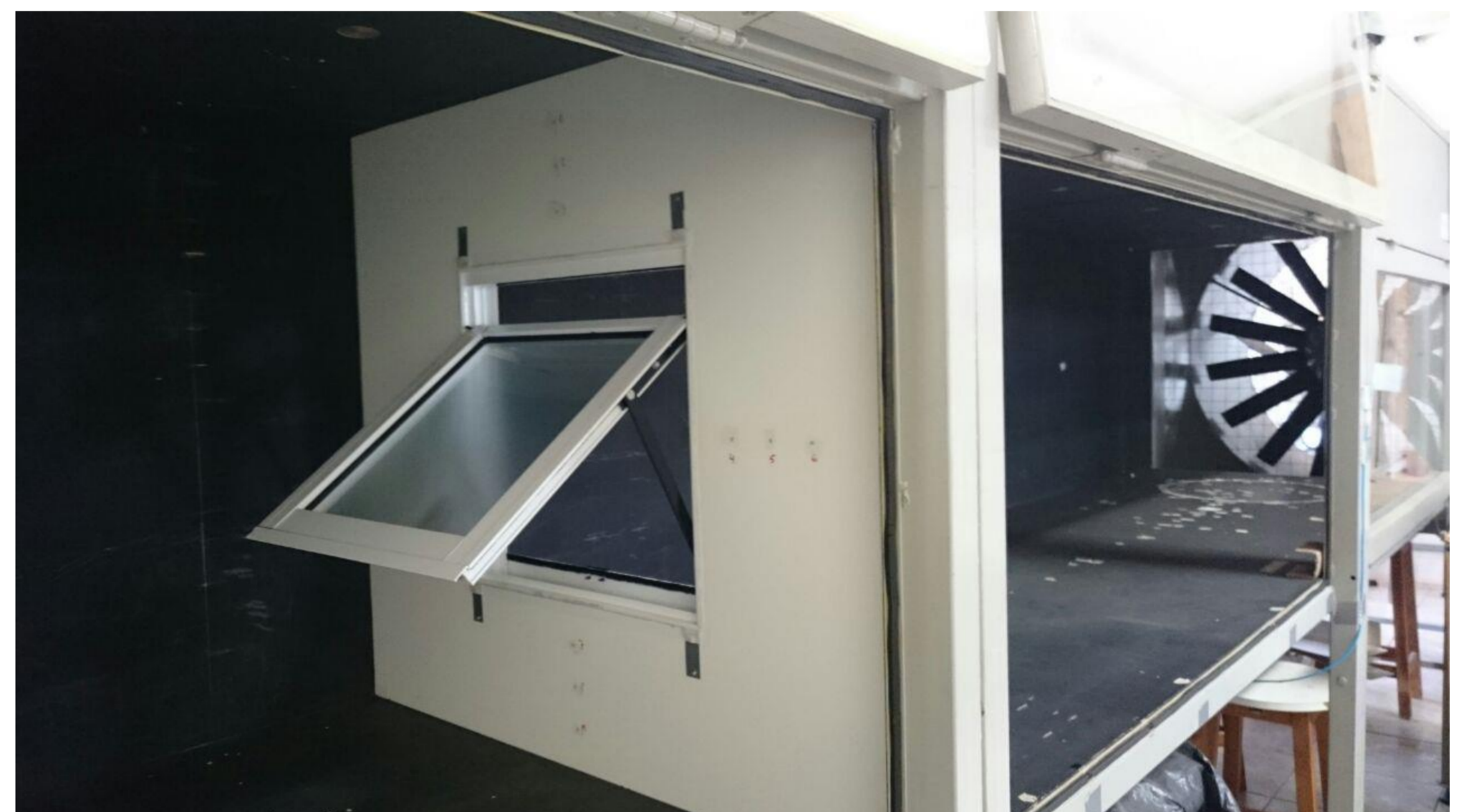
Fenster und Drucksensoren installiert im Windkanal
